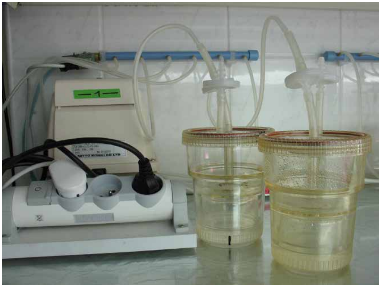
Ryc. 5. System służący do automatyzacji produkcji roślin w kulturze in vitro na przykładzie bioreaktora 'RITA'. Fot. Teresa Hazubska-Przybył.
