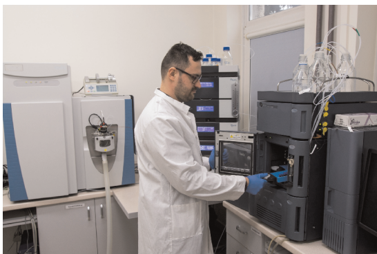
Fot. 19. Analizy roślinnych metabolitów wtórnych przy użyciu wysokorozdzielczego systemu chromatografii cieczowej i spektrometrii mas
